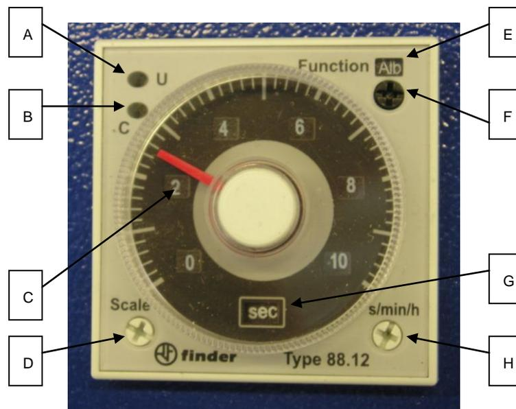
**A:** Gelbe LED: Betriebsspannung EIN / *Yellow LED: operating voltage ON*
